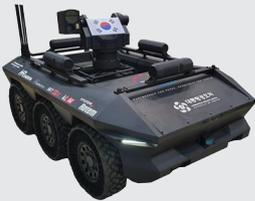
무인차량은 2005년 소방로봇을 시작으로 휠 독립구동 및 전기동력 기반으로 개발하고 있습니다. 완성차 개발과 병행하여 구동모터 및 현수장치 등 핵심부품을 자체개발하고 있으며, 특히 그룹사의 자동차 부품을 적극 활용하여 경제성과 안전성을 확보한 무인차량 개발에 노력하고 있습니다. 또한, 국과연과의 자율주행 실험차량 및 무인감시정찰 실험 플랫폼 연구를 수행하며 무인체계 관련 기술력 확보를 위해 노력했습니다. 최근 개발한 원격·자율주행 기반 무인차량인 HR-Sherpa를 통해 장애물 충돌 방지 기술, 물체추적 기술 및 경로계획 등 자율주행 기반 기술을 입증하였습니다.
