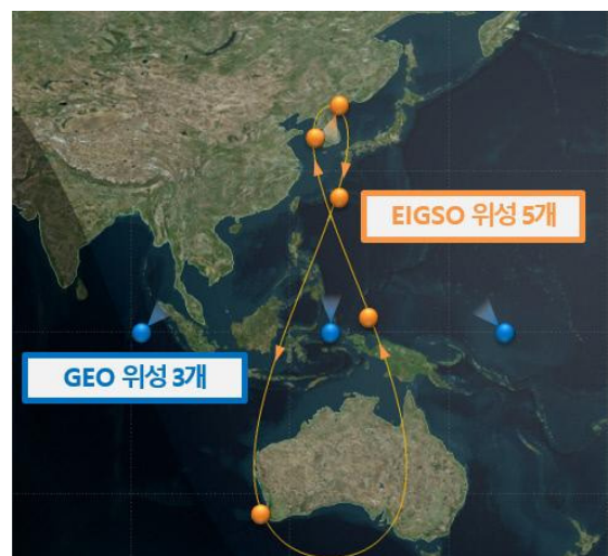
<그림 2> 한국형 위성항법시스템(KPS) 항법위성의 구성
